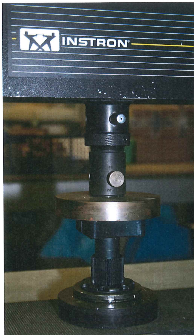
Fot. 1 Sposób badania wytrzymałości na ściskanie nóżek
