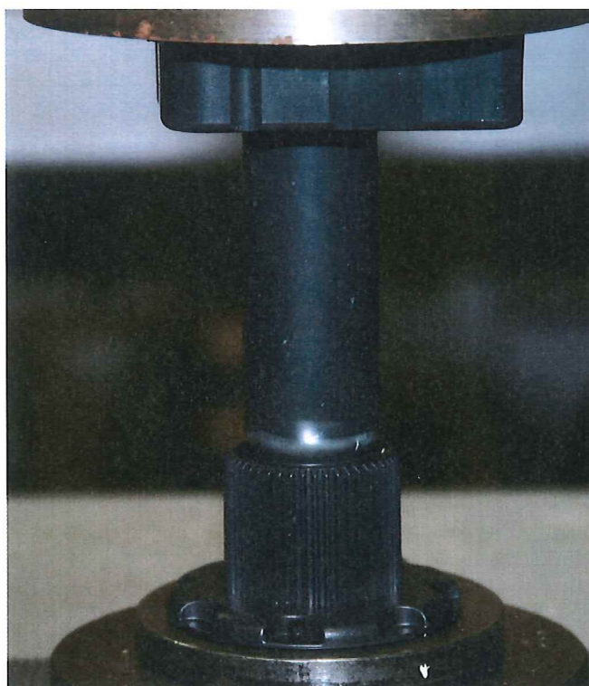
Fot. 4 Nóżka o wymiarze nominalnym 150mm (typowy obraz po badaniu)
