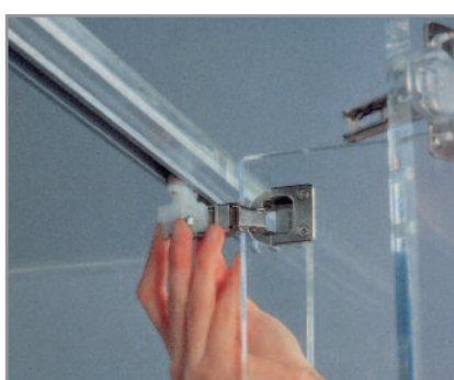
2 Zamontowanie zawiasa w szynie prowadzącej.
